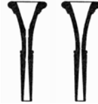
Skizze von zwei Hornmündstücke rechts mit weiterem und links mit engerem Kessel.
